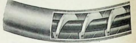
Durch eine Styroflexwendel isoliertes Koaxialkabel
